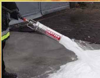
Dispositif mousse moyenne pour lutter contre les poussière inflammables, etc. Réf. art. 10.000.765
