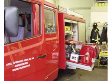
HDL 250 Agrégat installé avec 100 m de flexible
