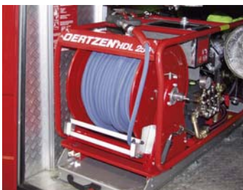
HDL 250 Agrégat installé (détail/100 m de flexible)
